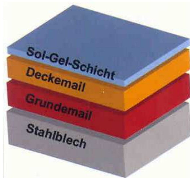
5. ábra Zománcozott acéllemez szól-gél bevonatának sémája
