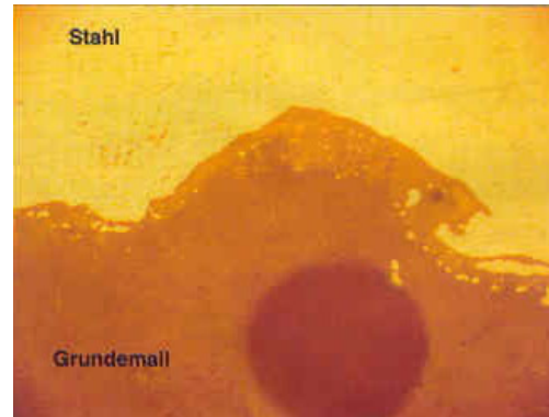
12. ábra Acélkorrózió alapzománc által (világos látótér)
