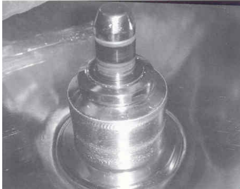
10. ábra Az elválasztó harang felületének állapota. A forgórész kerámiatengelye kopott, az elválasztó harang forgórésztől távol eső sík gyűrűfelülete sértetlen.
