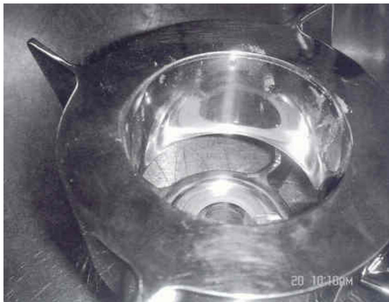
11. ábra A belső forgórész (keverőelem). Forgásirányú karcok alig észlelhetők, viszont több helyen, sűrűcsoportokban elhelyezkedő pontszerű bemarkódások láthatók.
