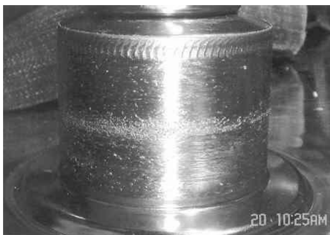
13. ábra Az RG szakemberei szerint, a forgó mágnesgyűrű síkjában, a mágneses tér által indukált örvényáram lyukkorróziót okozott.
