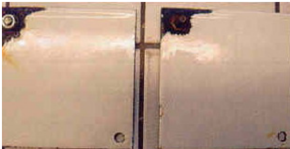
9. ábra Rozsdamentes acél (balra) és horganyzott (jobbra) csavarok hatásának összehasonlítása
