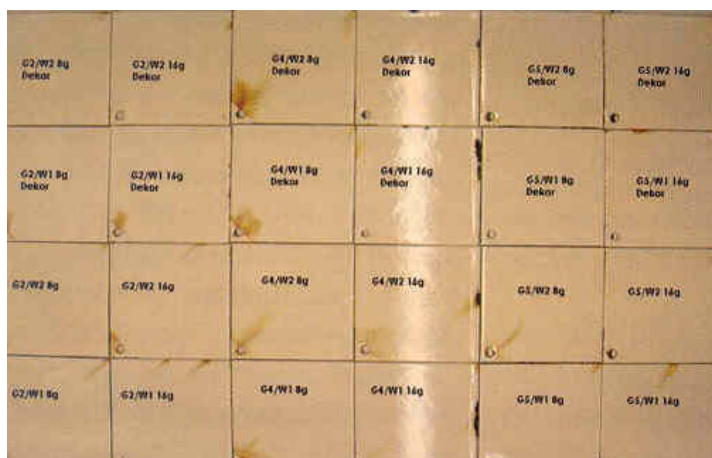
4. ábra Élrozsdásodás és rozsdacsíkok a próbalapokon
